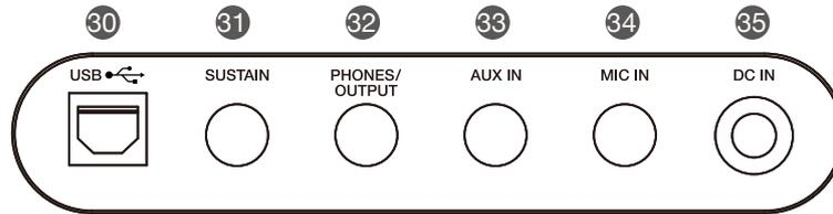
**30. Разъем USB** Подключите инструмент к компьютеру.
